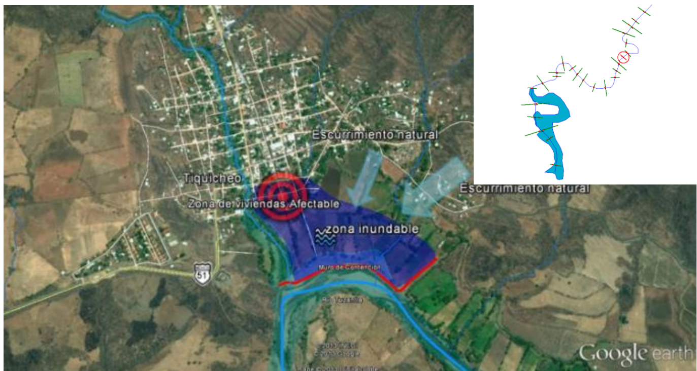
Imagen 122.- Imagen que muestra la ubicación del muro de contención al sur de la localidad de Tiquicheo y las zonas inundables debido al estancamiento del agua desbordada por el río y los escurrimientos naturales, Fuente: Elaboración propia en base a datos de visita de campo e imágenes satelitales, [imagen satelital Google Earth 2013], septiembre 2013.
